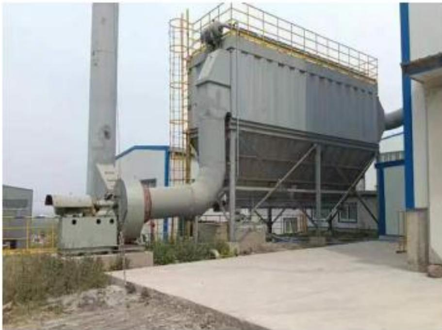
图 3-3 石子厂一次筛分厂房废气处理
