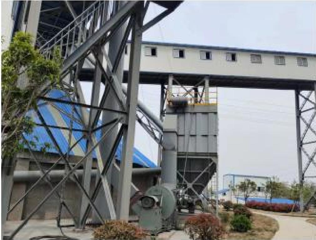
图 3-6 石子厂缓冲矿堆废气处理
